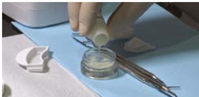
Fig. 7 + 8: Le matériau obtenu broyé et filtré est immergé, pendant 10 minutes, dans une solution nettoyante appelée «Cleanser», qui contient de l'hydroxyde de sodium avec 20% d'éthanol.
