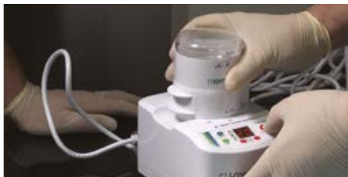
Fig. 4-6: Le compartiment est bien fermé. Le procédé GRIND (BROYER) est ajusté à 3 secondes et SORT (TRIER) à 20 secondes. Pour démarrer le broyage, il faut appuyer sur START (DÉMARRER). Après le bruit fort du broyage, on entend un bruit vibrant, où les granulats sont triés et collectés dans les deux compartiments de filtration.
